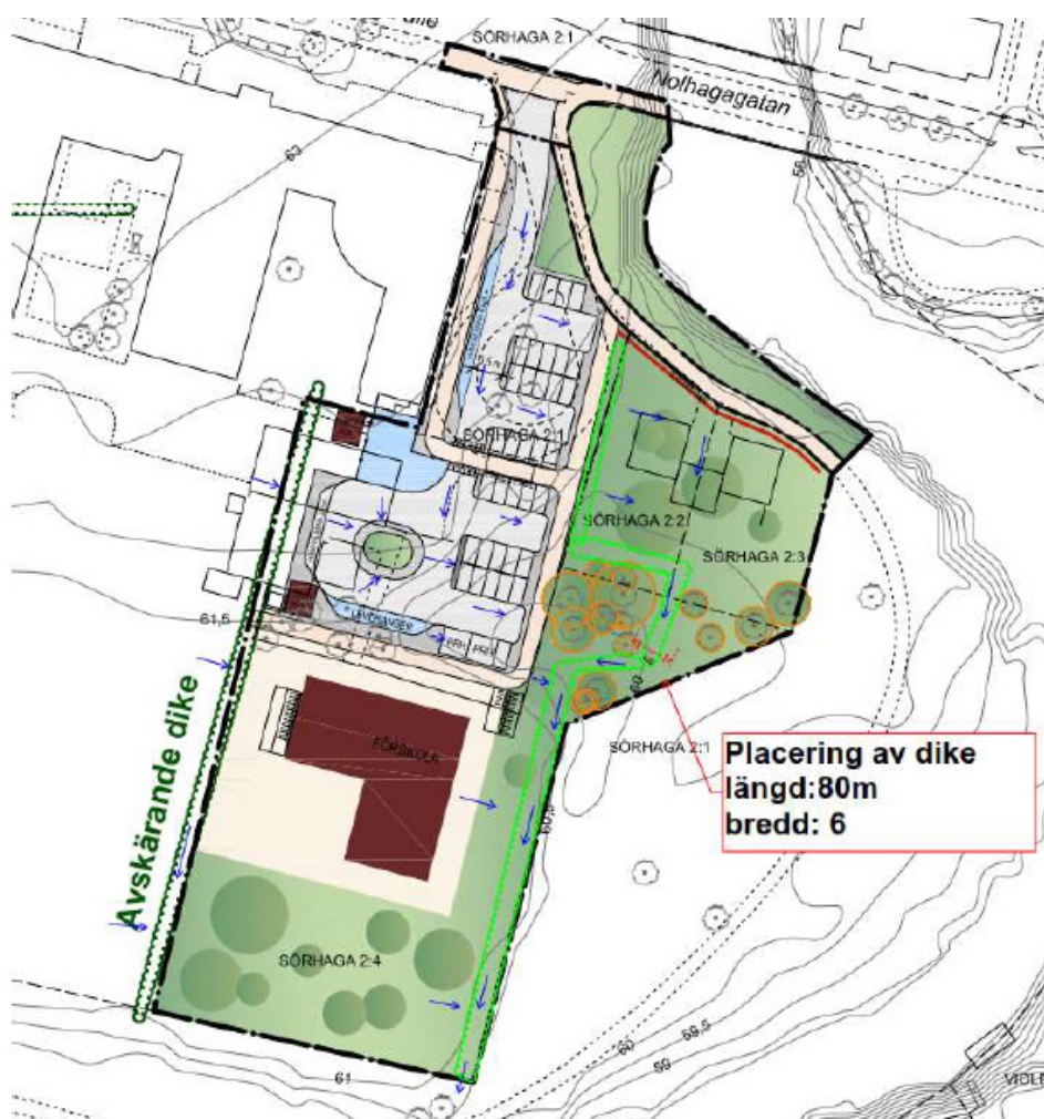
Föreslagen dagvattenhantering inom detaljplanen. Avskärande dike väster om förskolan och svackdike.
